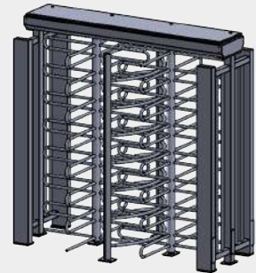
DUBBELE DRAAITROMMEL 15 passages/min. Asverdeling 120° of 90° 2 voetgangers tegelijk
